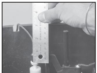
*Interruptor de flotador superior 7,60 cm (3") por debajo de la parte superior del recipiente*
